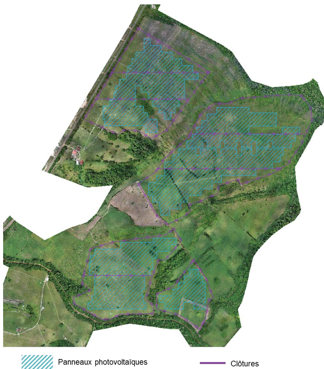
Figure 5. Plan d'implantation des panneaux agrivoltaïques.
